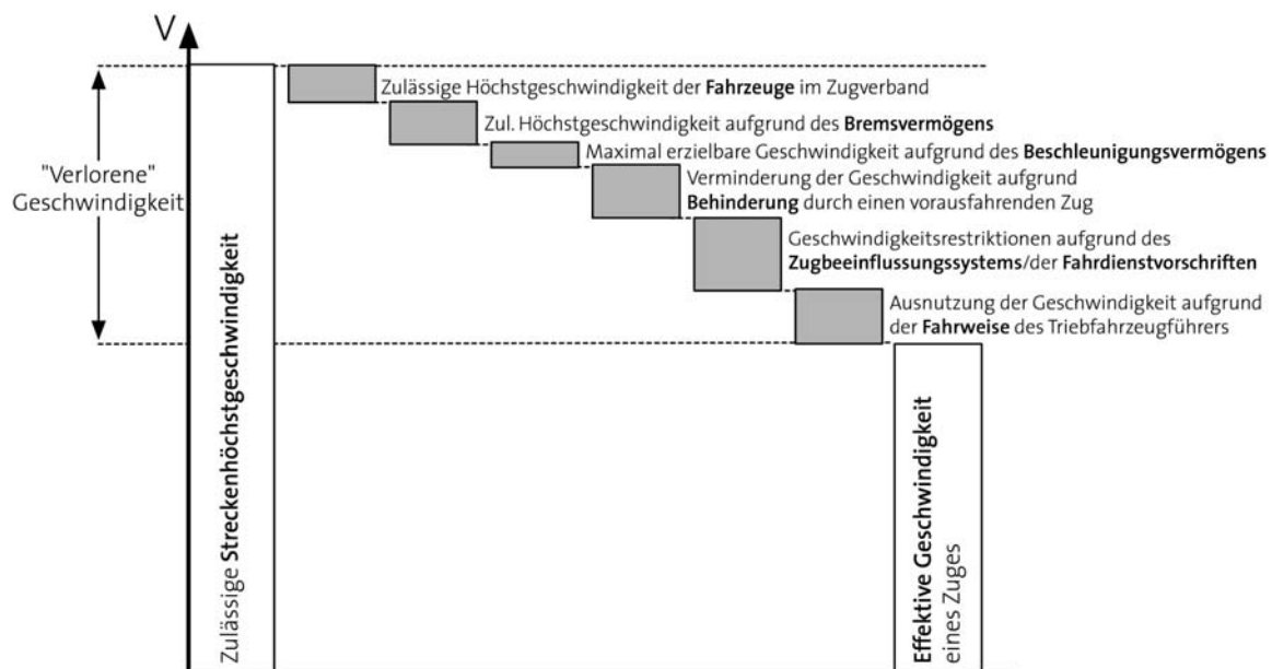
Abbildung 5-3 „Geschwindigkeits-Kaskade“ – Einfluss verschiedener Faktoren auf die effektiv gefahrene Geschwindigkeit eines Zuges [eigene Darstellung]
