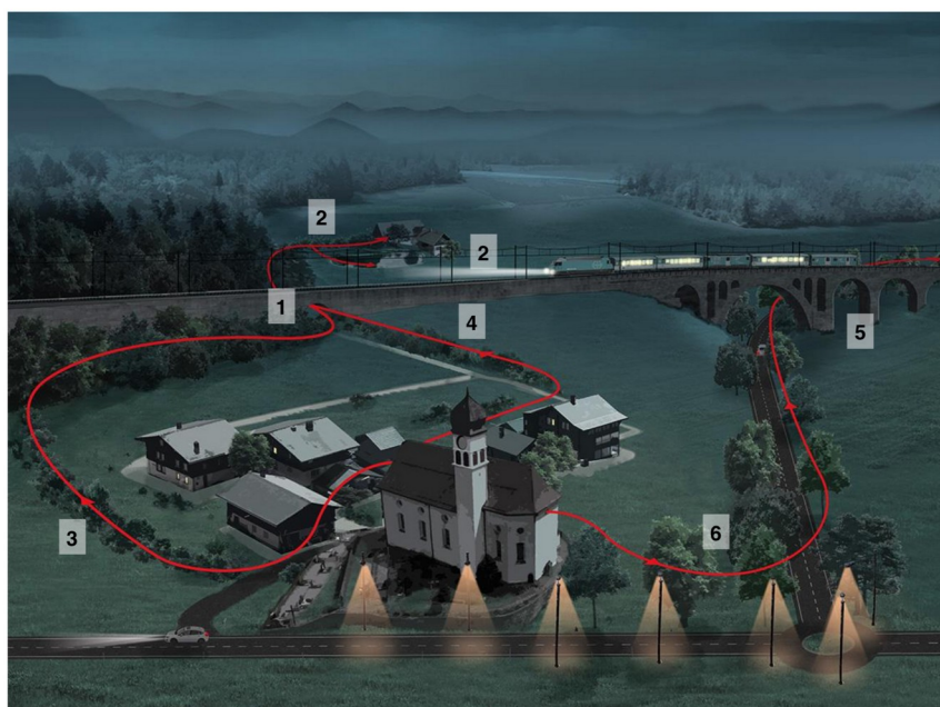
Massnahmen zu Gunsten der Fledermäuse verbunden mit Verkehrsinfrastrukturprojekten: 1) Verbesserung einer Wildtierbrücke; 2) Verlegen einer Hecke, die als Flugkorridor dient; 3) Verstärkung eines Flugkorridors im Rahmen einer Gewässerrenaturierung; 4) Pflanzen einer Leitstruktur, die Fledermäuse zu einem bestehenden Bauwerk führt; 5) Aufwertung eines Quartiers in einem Viadukt; 6) Beleuchtungskonzept, das die Baumallee möglichst nicht beleuchtet; Ausgangssituation ohne Massnahmen: siehe Abbildung 10, S. 15.
