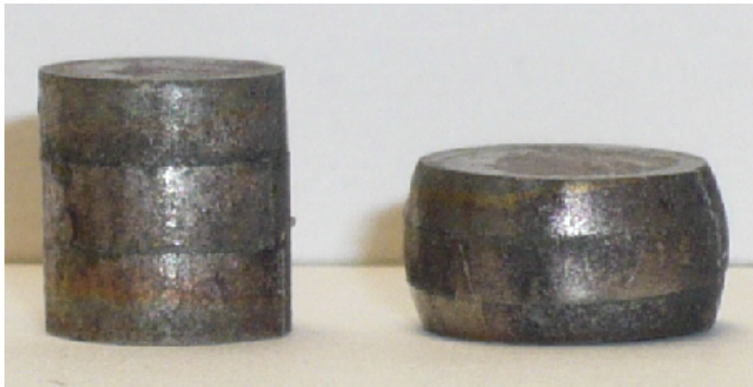
Abbildung 3.7: Undeformierte und deformierte Schichtstauchprobe.
