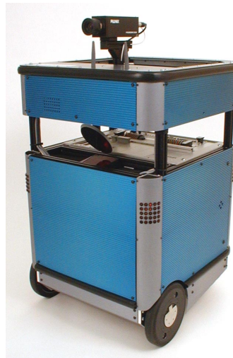
Figur 1: Pygmalion, der Roboter auf welchem die Experimente durchgeführt wurden. Es handelt sich um ein VME-basiertes System mit einer Robotersteuerung für 6 Achsen. Die Prozessorkarte trägt einen PowerPC bei 300 MHz. Neben Rad-Encodern und taktilen Sensoren, beherbergt das Vehikel einen Laserscanner und ein Videosystem (siehe Kapitel 2)
