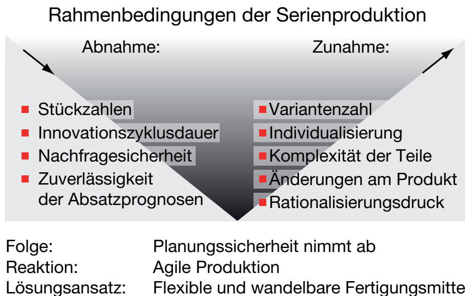
Bild 1.1: Gegenüberstellung von Einflussgrößen, deren Änderung die Rahmenbedingungen der Serienproduktion geprägt hat. Die abnehmende Planungssicherheit erfordert neue Lösungsansätze mit neuartigen Produktionsmitteln.
