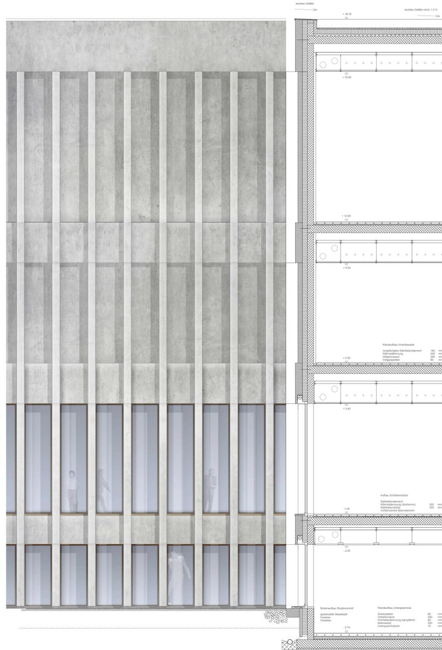
Konstruktionsschnitt durch Hofassade Mst. 1:50
