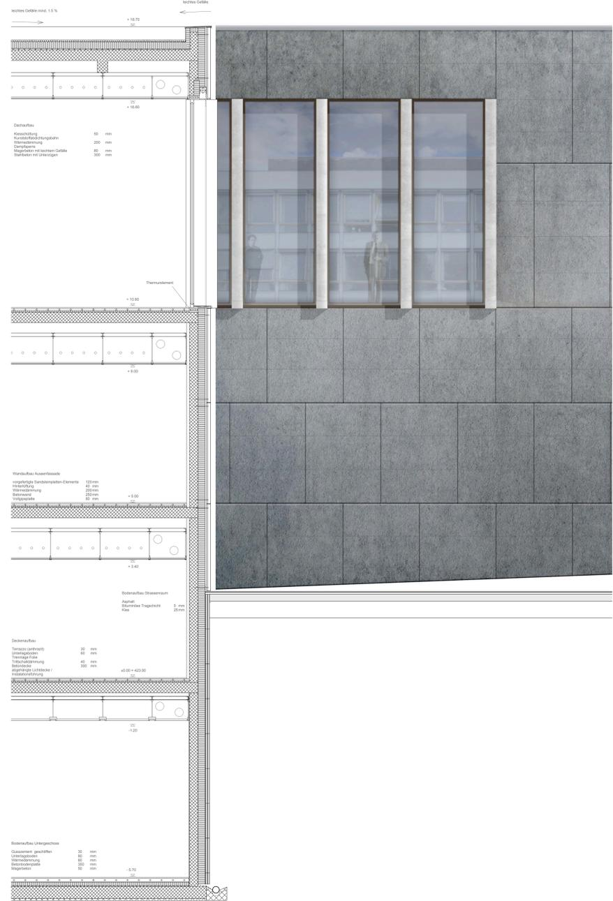
Konstruktionsschnitt durch Strassenfassade Mst. 1:50
