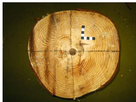
Abb. 1 Stammabschnitte a mit 30 mm Bohrung b mit 100 mm Bohrung und Sägespanfüllung Fig. 1 Wood samples a with a hole of 30 mm diameter b with a hole of 100 mm of diameter and filled with strands
