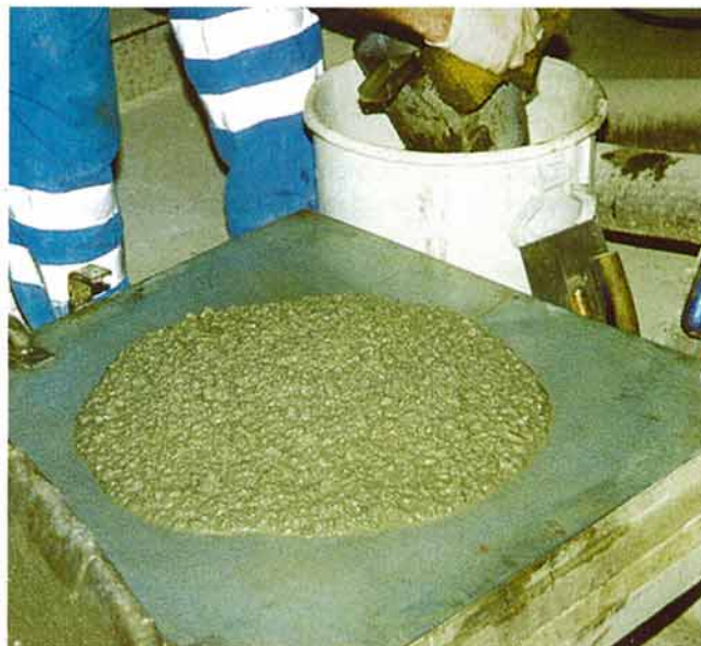
1 SCC-Beton bei der Konsistenzermittlung
