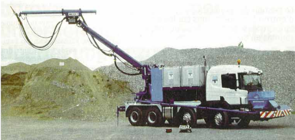
2 Spritzmobil mit Funkfernbedienung (Quelle: MBT)
