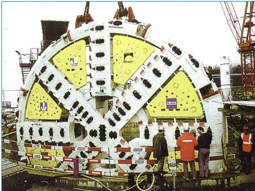
6 Tunnelvortriebsmaschine mit Mixschild – Tunnel Zürich–Thalwil (Quelle: Herrenknecht)
