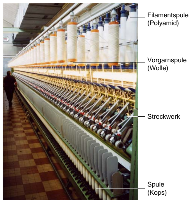
Abb. 111 Eine der 58 Ringspinnmaschinen des untersuchten Arbeitssystems.
