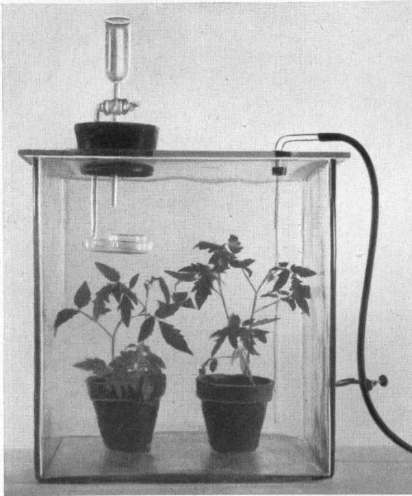
Abb. 3. Versuchsanordnung zur Verabreichung von ^{14}\text{CO}_2 an infizierte Tomatenpflanzen; Maßstab 1 : 5 (Aufnahme: Lilly Trüb, Zürich)
