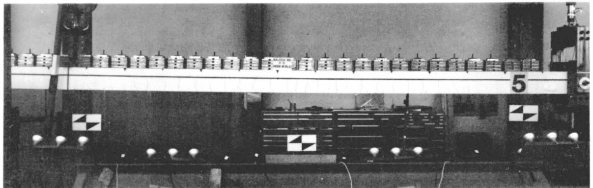
Vor Versuch B5.1: Rissbildung unter Eigengewicht mit Blei
