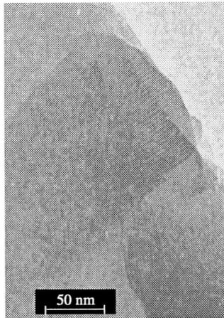
**Abbildung 4-2.** TEM-Bild der lamellaren Strukturierung im Randbereich der Plättchen des getrockneten Gels.
