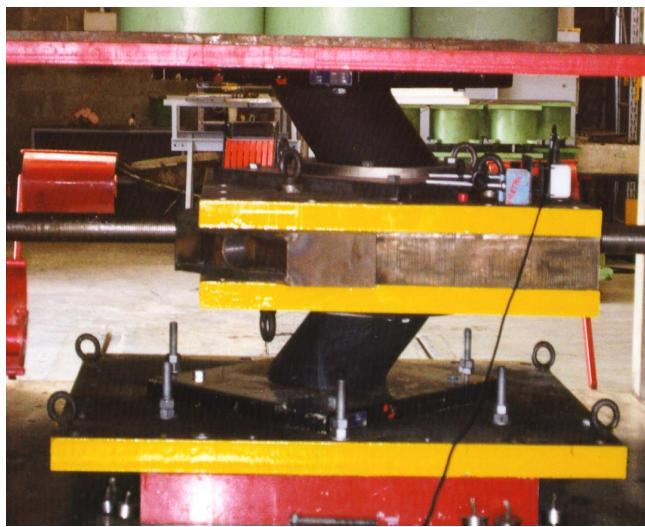
**Bild 8 - Verformung von zwei Erdbebenlagern beim statischen Bruchversuch**
