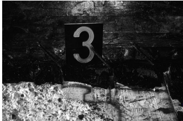
**Abb. 21** - Äussere SFS Schrauben beim BSH-Balken Nr. 3 der Holz-Beton-Verbunddecke mit SFS Schrauben vollständig freigebrannt. Versagen der Verbundfuge zwischen Beton und Holz nach 67 Min.
