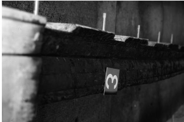
**Abb. 20** - Leimversagen in der Fuge zwischen der zweiten und dritten Lamelle des BSH-Balkens Nr. 3 bei der Holz-Beton-Verbunddecke mit ins Holz gefrästen Kerben und Hilti Dübeln nach 63 Min.
