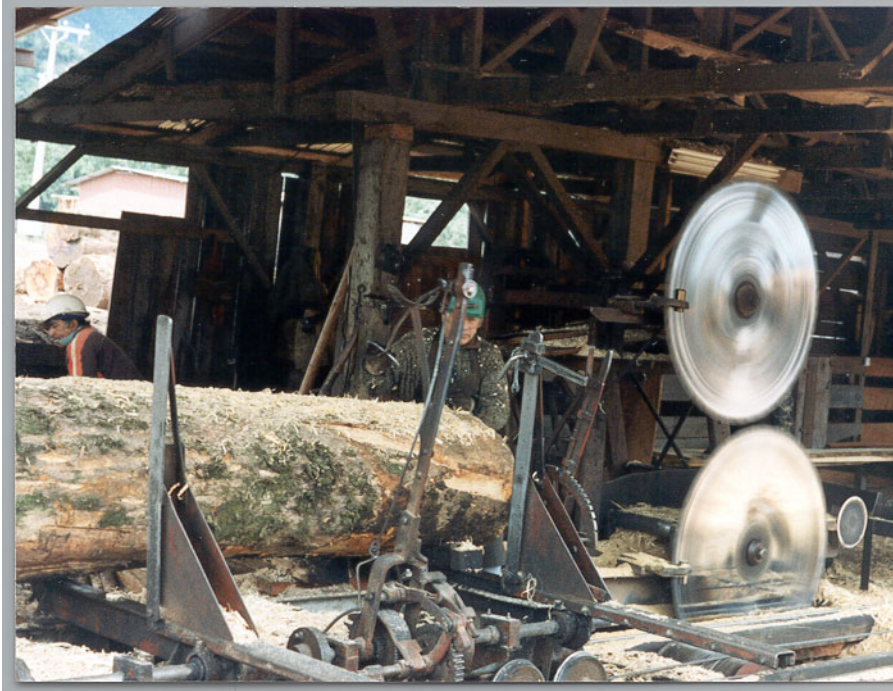
Abbildung 24: Kreissägemaschine zum Rundholzeinschnitt in Chile
