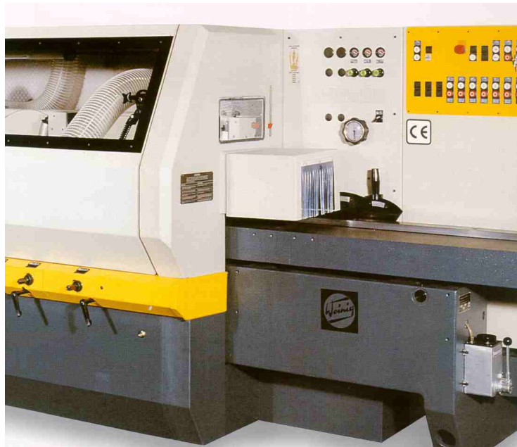
Abbildung 14: Vierseitenhobelmaschine zur Bearbeitung von Vollholz (Fa. Weinig)
