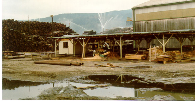
Abbildung 8: Besprühen von Rundholz zwecks Verhinderung von Bläue
