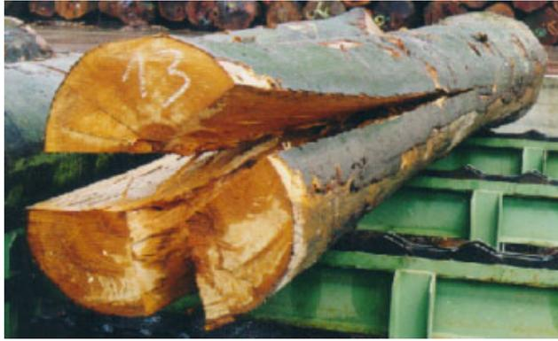
**Abbildung 15** Rissbildung in Rotbuche durch Eigenspannungen (Foto: Uni Freiburg)
