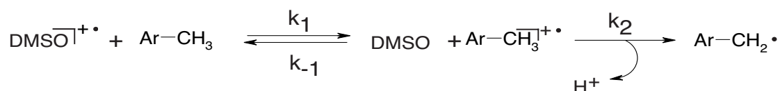
Schema 8.6-6 Elektronentransfer von einem Aromaten auf das DMSO-Radikalkation.
