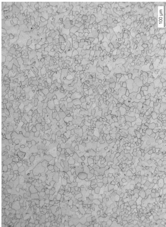
Abb. 1-7: Mikrogefüge von Reintitan mit rekristallisierten \alpha -Körnern.
