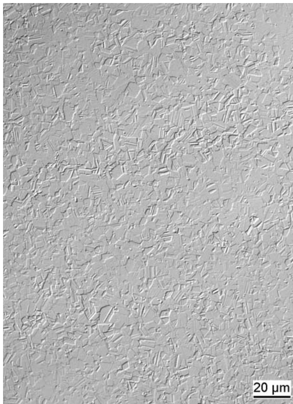
Abb. 1-10: Mikrogefüge einer CoCr (wrought) Legierung mit niedrigem Kohlenstoffanteil ( C < 0,08\% ). Das Gefüge ist rein austenitisch.
