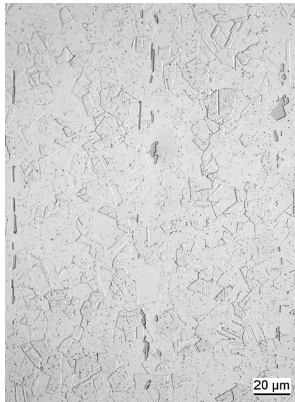
Abb. 1-12: Mikrogefüge der stickstoffhaltigen Stahllegierung nach ISO 5832-9 (wrought) im Längsschliff. In der austenitischen Matrix sind fein verteilte [Cr,Mo]-Karbide und zeilenförmig angeordnete [Cr,Nb]-Nitride ausgeschieden.
