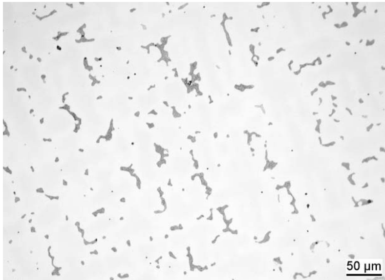
Abb. 1-9: Mikrogefüge einer CoCrMo-Gusslegierung mit primären Karbiden (dunkle Phasen).
