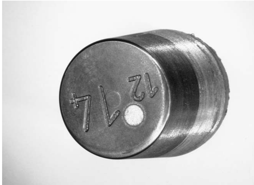
Abb. 2-1: XPS-Messung an der Stirnfläche eines schwarz verfarbten Konus. Der runde, weisse Fleck an der Stirnseite ist der Messfleck, der durch Ionenbeschuss abgetragen und analysiert wurde. Probe R990233.
