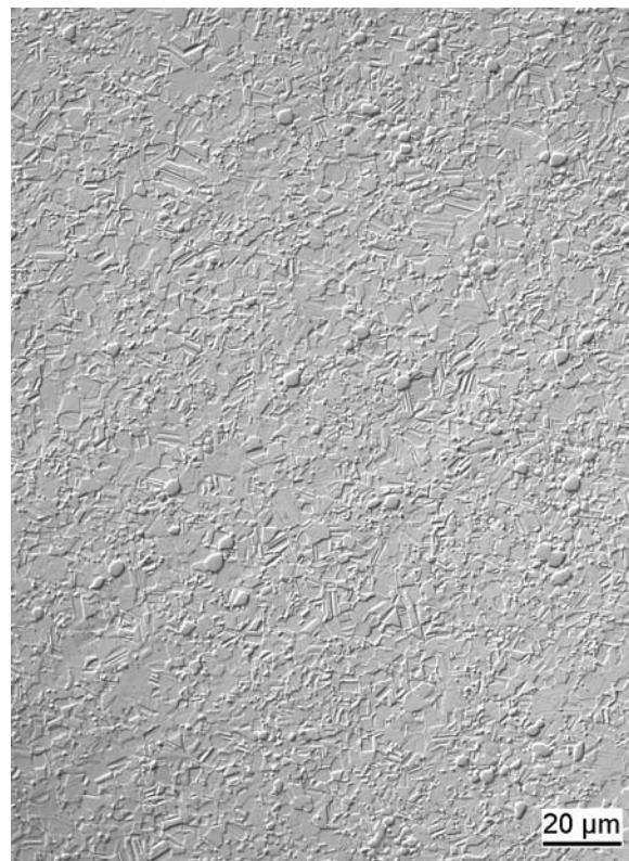
Abb. 1-11: Mikrogefüge einer CoCr (wrought) Legierung mit hohem Kohlenstoffgehalt ( C 0,2\% ). In der austenitischen Matrix sind Karbide eingebettet.
