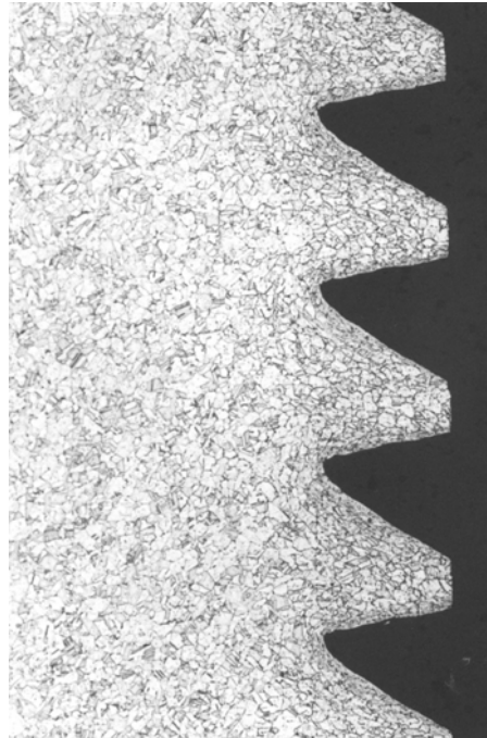
Abb. 1-5 Struktur im Querschnitt eines Schaftkonus von Centerpulse Orthopedics. Die Tiefe der Struktur beträgt 90 \mu\text{m} .
