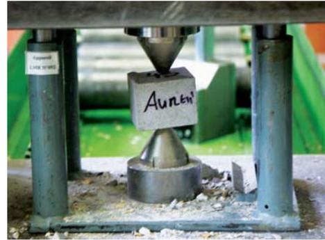
Abb. 7.2: Versuchsanordnung des Punktlastversuches.
