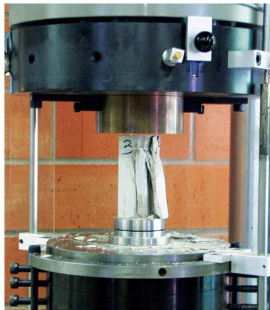
Abb. 7.1: Versuchsanordnung des einaxialen Druckversuchs
