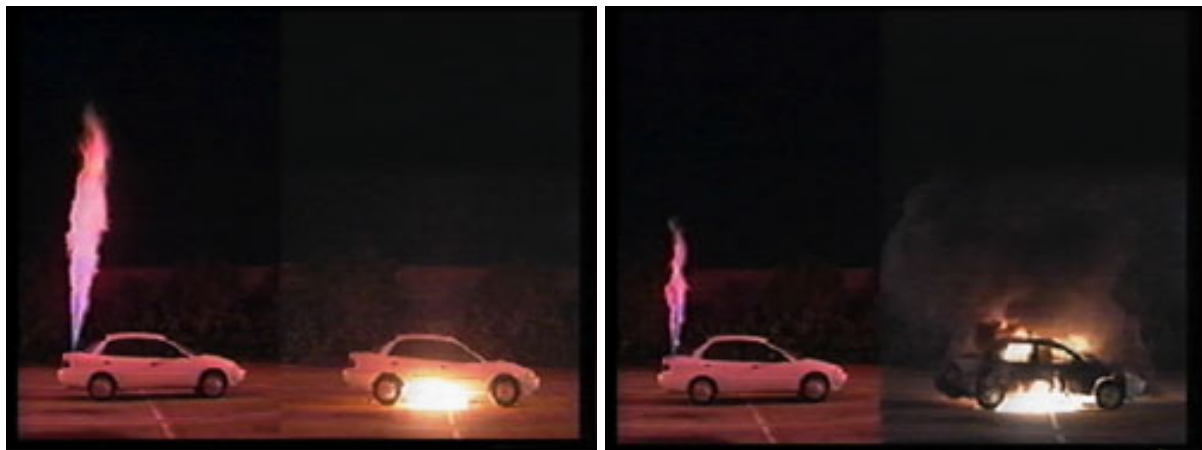
Bild 2.1: Direktvergleich zweier Fahrzeugbrände dreissig Sekunden (linkes Bild) und eine Minute nach Feuerausbruch (rechtes Bild); links im Bild jeweils ein Fahrzeug mit Wasserstofftank, rechts ein solches mit Benzintank [8].
