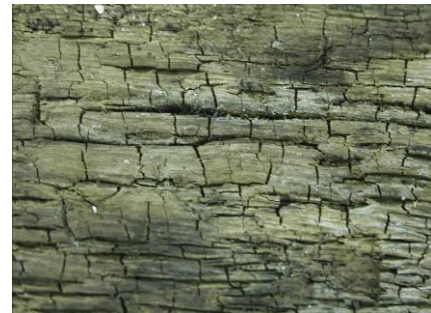
Abbildung 53 Dunkelfärbung und kleinteiliger Würfelbruch durch Moderfäulepilze
