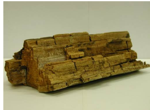
Abbildung 33 Braunfäule mit typischem Würfelbruch
