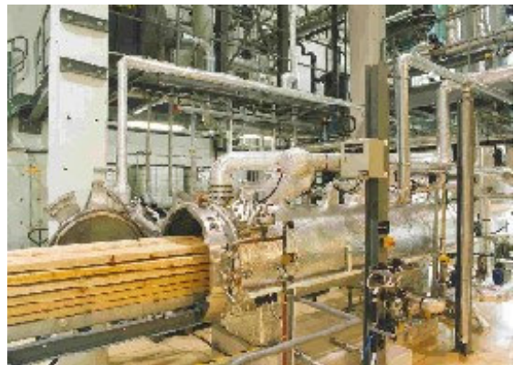
Abbildung 75 Acetylierungs-Anlage in der Industrie
