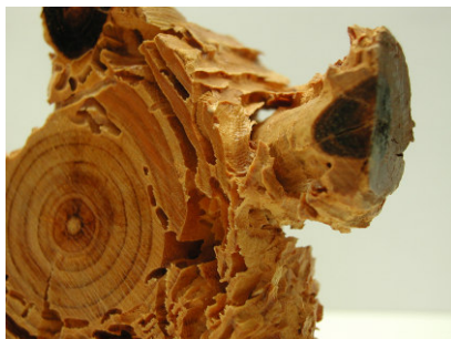
Abbildung 62 Frassgänge mit typischen Rippelmarken, Hausbockweibchen mit Ausflugloch, Larve (Quelle mitte und rechts: www.pentol.ch )
