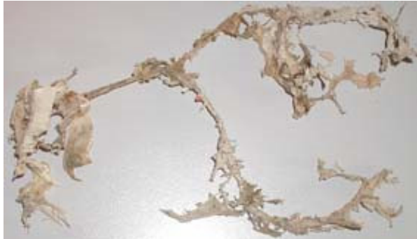
Abbildung 45 Strangmyzel des Echten Hausschwammes (Quelle: www.holzfragen.de )
