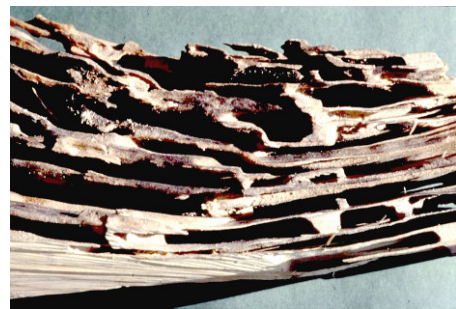
Abbildung 59 Durch Pilze und Ameisen zerstörtes Stück Holz
