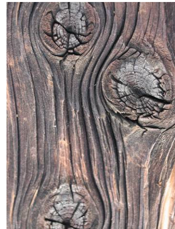
Abbildung 25 Reliefstruktur an altem bewittertem Holz
