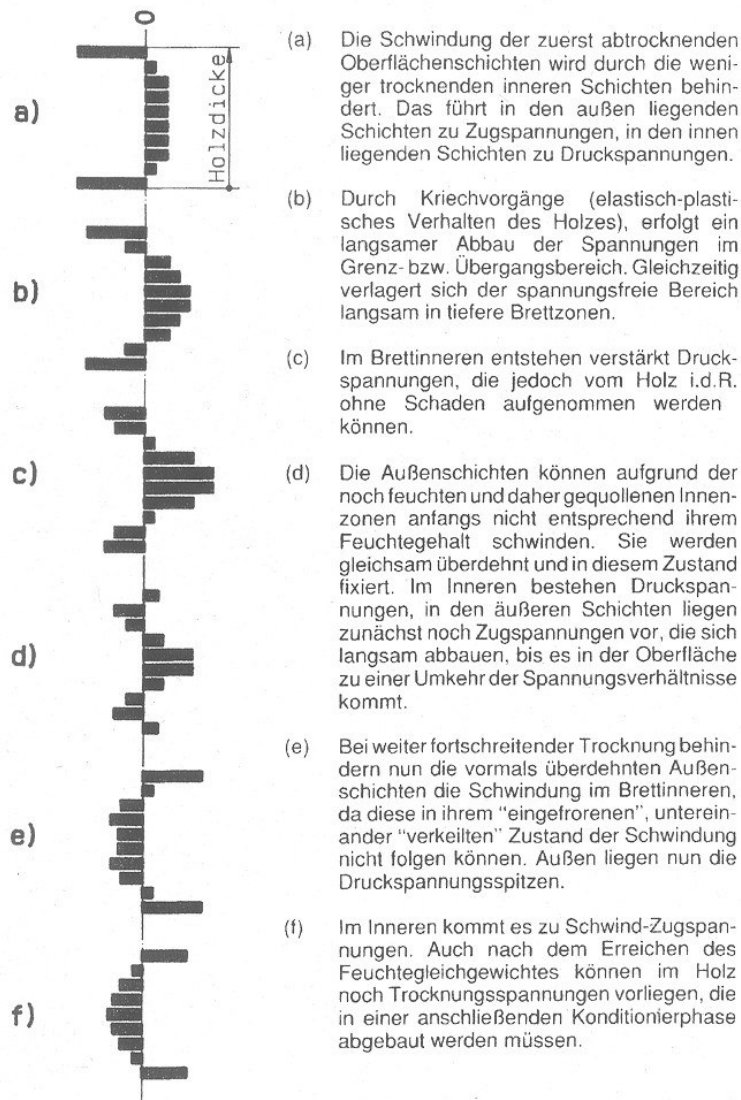
Abbildung 7: Ausbildung des Feuchteprofils und der Spannungen bei der Holz Trocknung
