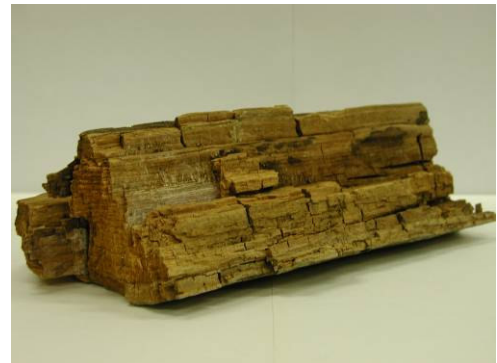
Abbildung 33 Braunfäule mit typischem Würfelbruch
