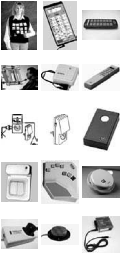
Auswahl an technischen Hilfsmitteln der FST (Fondation Suisse pour les Télépathes), Neuchâtel. U.a. tastenbesetzter Pullover, individuell programmierbare Infrarotfernsteuerung, Buchblätterhilfe, infrarotgesteuerter Jalousieantrieb, infrarotgesteuerter Steckdosenaufsatz. Quelle: http://www.fst.ch
