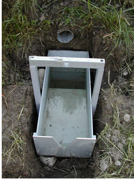
Abbildung 5.1: Auslass unterhalb der Probenahmestelle, wo kontinuierlich (alle 15 Minuten) Temperatur, Leitfähigkeit und Sauerstoff gemessen wurden.
