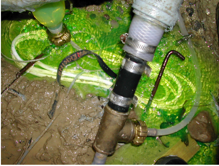
Abbildung 6.3: Aufnahme der Sammelstelle während des Experimentes: aus dem ‘geplanten’ Auslass (der Rohr mit einer Verzweigung) floss kein Wasser. Das Wasser enthält hier den Tracer Uranin.
