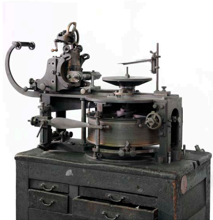
Abbildung 3: Schwilgués Zahnradfräsmaschine © Historisches Museum, Strassburg. Bild: Strassburger Museen, M. Bertola
