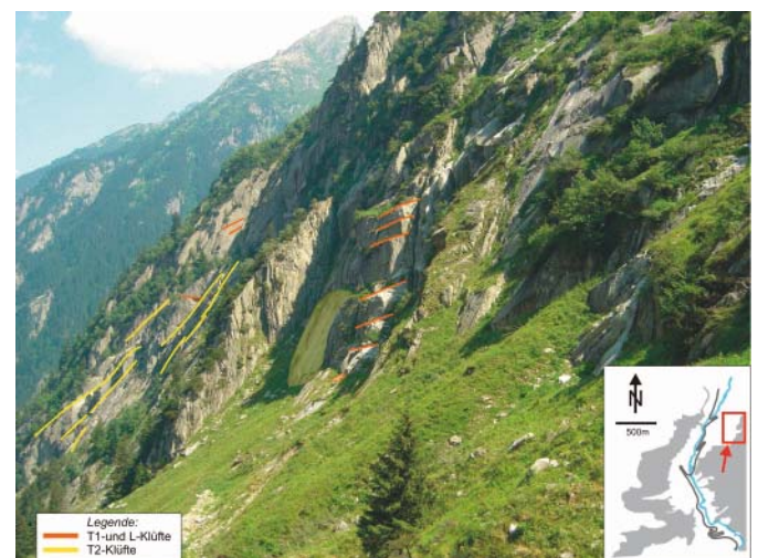
Fig. 11. Photographische Analyse der Trennflächen-Systeme in den unzugänglichen Felswänden der Schöllenschlucht, Ostseite (gleiche Darstellung wie Figur 9).
