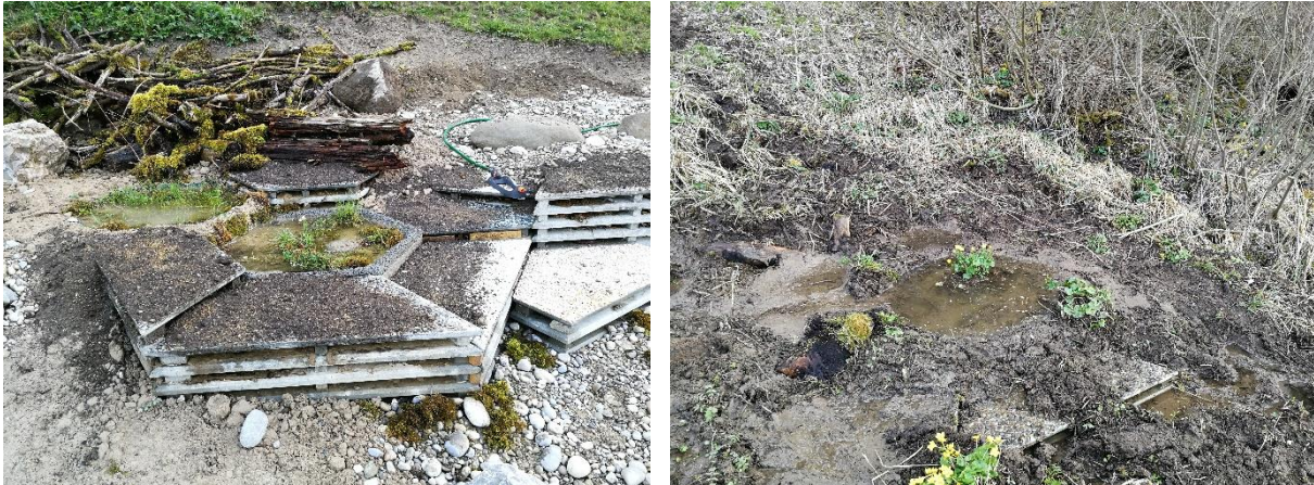
Abbildung 1: Prototyp eines Ökomoduls mit zwei Tümpeln (links). Ökomodul mit einem Tümpel in den Hang eingebaut (rechts). Die Betonplatten sind hier nur noch vereinzelt sichtbar.
