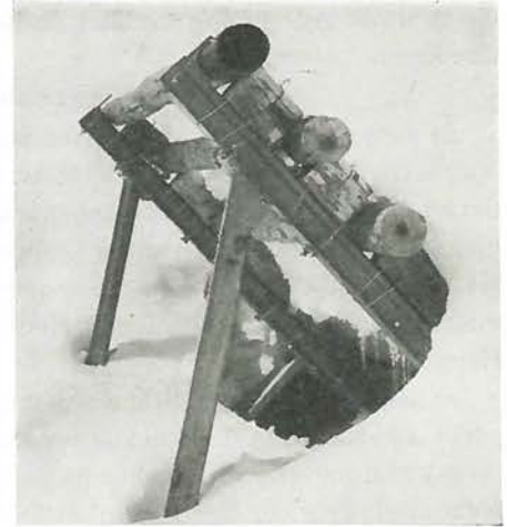
Fig. 39 Drehbock. Werk 12. Brückenelement ohne Trägerfundament, das um die Fußpunkte der Stützen frei drehbar ist. Unter dem mittleren Balken sind Druckdosen sichtbar. (Photo M. de Quervain)
