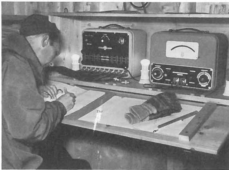
Fig. 44 Apparatur für elektrische Dehnungs- und Druckmessung (Philips) in der Schutzhütte der Versuchsverbauung. Instrumente in thermostierten Kästen. (Photo Truöl)
