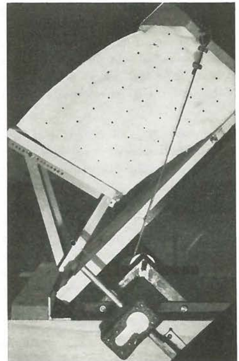
Fig. 40 Modellversuch zum Drehbock. Der Bock wird durch den Schneedruck ein Stück weit abgehoben und stabilisiert sich selbst, sofern durch die Bewegung das Kraftbild derart verschoben wird, daß die Resultierende aller Kräfte in die Drehachse zu liegen kommt. (Photo M. Zehnder)
