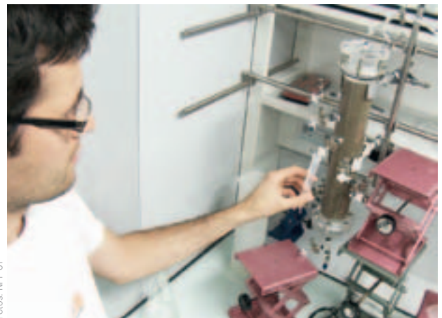
Mit Flusssediment gefüllte Plexiglassäulen geben Auskunft über die biogeochemischen Prozesse beim Versickern.
