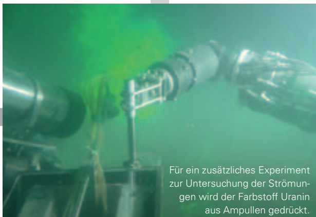
Der Greifarm fasst die Kunststoffröhren, um sie in den Grund des Genfersees zu rammen.
