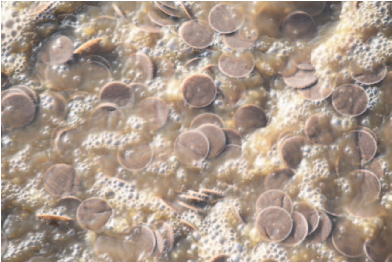
Wirbelbett: Kunststoffteilchen im Abwasser verbessern den Abbau gewisser Mikroverunreinigungen.
