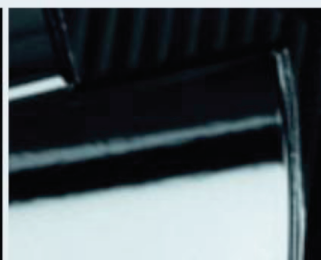
Oberflächenfehler sind im Übergang des Spiegelbildes einer hellen und einer dunklen Fläche (Deflektometrie) einfacher zu erkennen.
