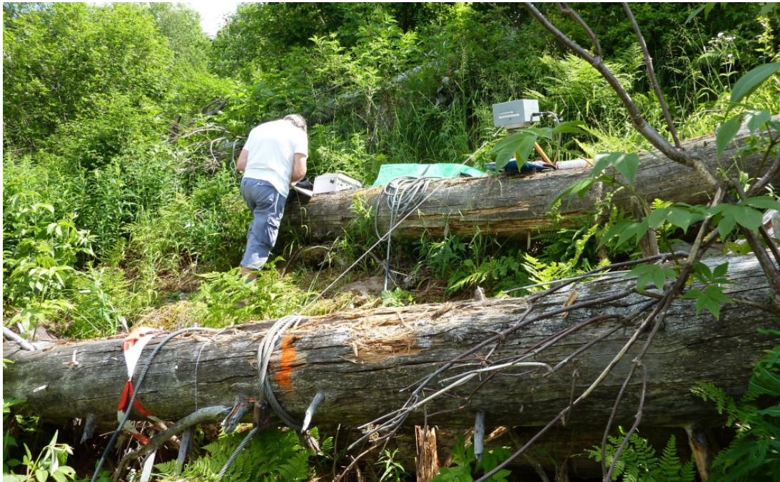
Abb. 23: Einrichtungen für die Zugversuche auf der belassenen Windwurffläche in Disentis. Messapparatur, welche die Bewegungen der Stämme registriert. Quelle: Putallaz (2010)
