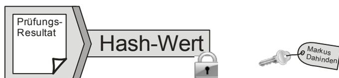
**Abbildung 4.34: Digitale Signierung eines Dokuments.** Die eindeutige Prüfsumme (*Hash*) eines Dokuments wird mittels eines digitalen Schlüssels chiffriert. So kann nachträglich die Unversehrtheit des Dokuments kontrolliert werden.
